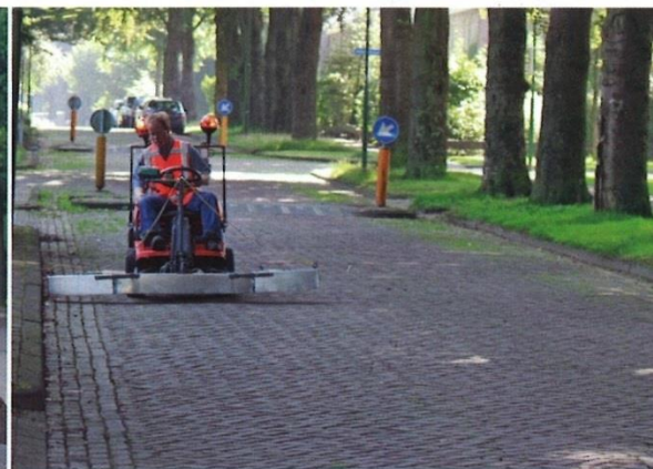
Alfred bouwde een opklapbare spuitbalk op een Husqvarna-grasmaaier. Die combinatie wordt in de zomermaanden ingezet voor het schijfverveelen van onverdunde Roundup bij onkruidbestrijding.
